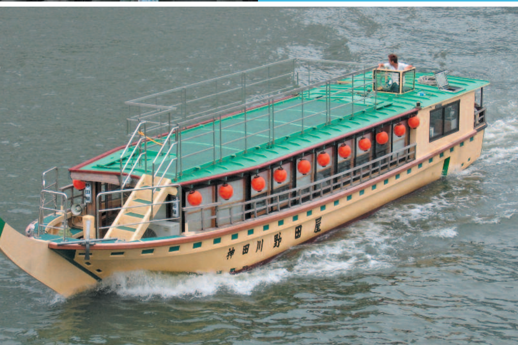
Un Yakatabune descend la Sumida. Les rambardes sur le pont peuvent se replier pour passer sous les ponts à faible tirant d'air.
